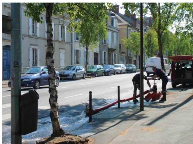
**Figure 35** : Pesée d'un hydrant par le service départemental d'incendie et de secours
